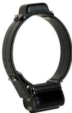
Obr. 2 Satelitný telemetrický obojok Tellus Small
